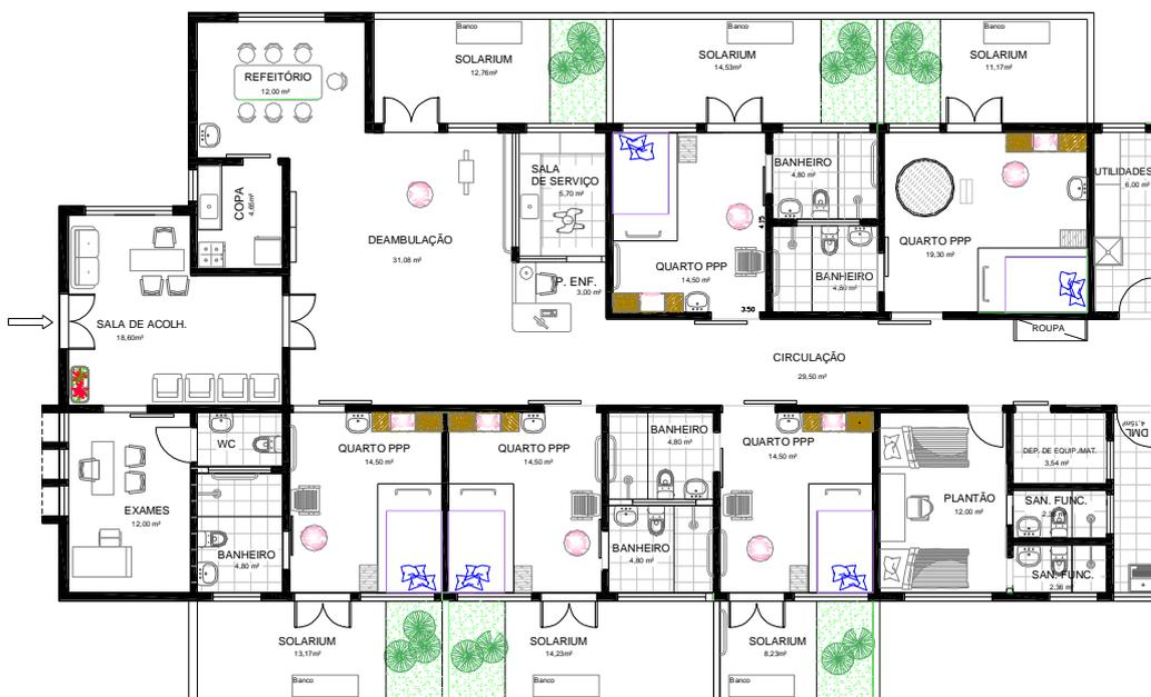
Figura 03 – Planta de referência de um Centro de Parto Normal (CPN).
